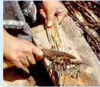
③表面を削り取った樹皮を黒皮次ぎが白皮といい、黒皮は水に浸しておく。
